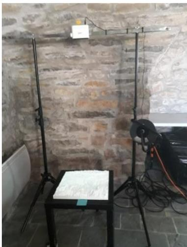
Un support permet de placer le pico-projecteur à la hauteur souhaitée. Il suffit alors de projeter les données issues de logiciel SIG ou modélisées, pour obtenir une maquette interactive évolutive des projets à présenter. Il est à noter que, pour que la visualisation soit parfaitement exacte, des corrections géométriques du relief et des corrections d'erreurs de parallaxe de la lentille du projecteur devront être effectuées.
